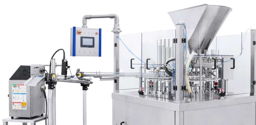
Obr. 1.11 Automaticky plniaca a baliaca linka pre potravinársky priemysel
