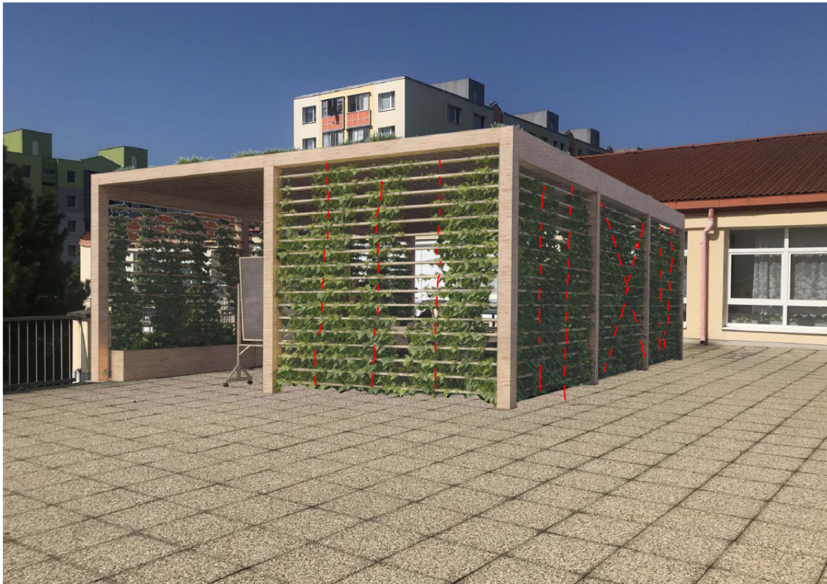
Obr. 1 Vizualizácia objektus vyznačením ťahadiel a zavetrenia
